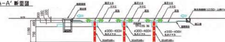
図2 スティックフィルター標準構造図
